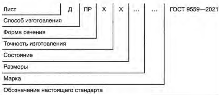
Рисунок 1 — Схема условного обозначения листов
